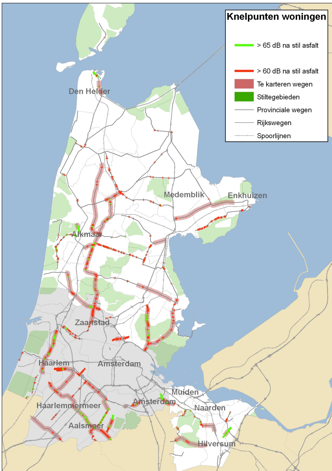
Figuur 7. Overschrijding plandrempel van 65dB ná de toepassing van stil asfalt. Het gaat om de groen gearceerde weggedeelten. Zie ter vergelijking figuur 5.
