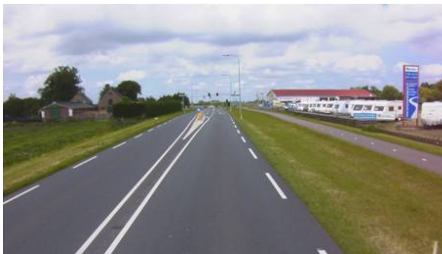
Figuur 35: Niveau R voor stroomwegen (circa 80 km).
