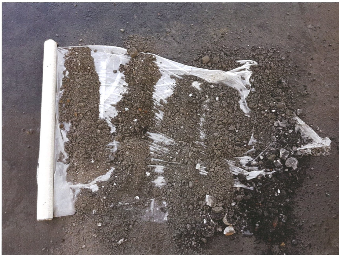
Boring bij DKM18, diepte ca. 5,0 m, na 3,5 m beton en asfalt
